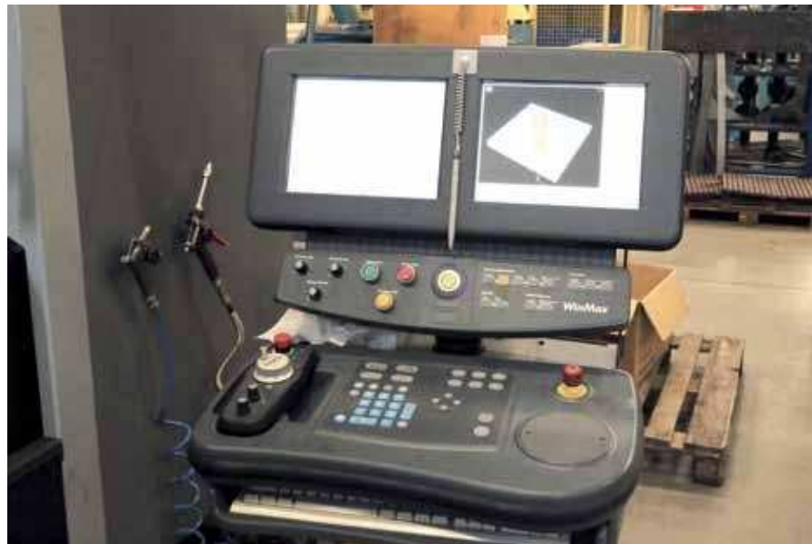
Die Hurco-eigene Steuerung ermöglicht das direkte Einlesen von DXF-Zeichnungen und eine direkte Umsetzung mit Simulationsmöglichkeit.
